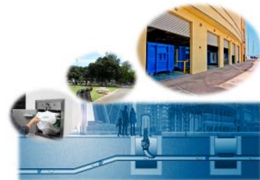
九龍灣行動區的自動廢物收集系統及 廢物／廚餘處理設施
