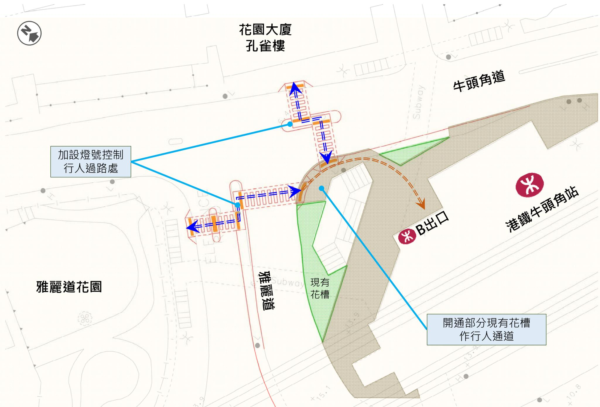
圖四 方案(三) 牛頭角道和雅麗道路口加設地面行人過路處
